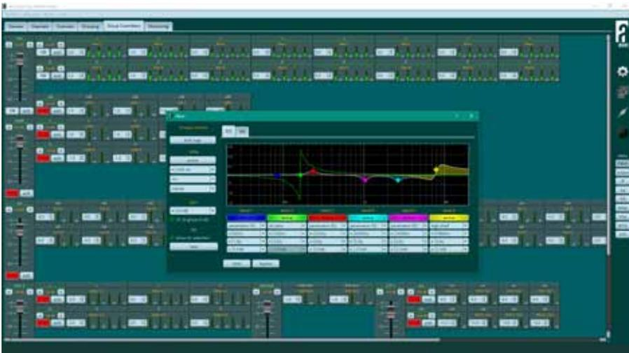
本番中はシステムのパフォーマンス=動作、インピーダンス、出力電圧、内部コンポーネントからのフィードバックがトレースされ、リアルタイムに表示されます。エラーが起こると、プログラムのどのページが画面に表示されているかに関係なく、即座にエラー通知が表示されます。
