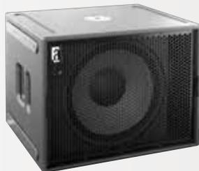
● 歪みが非常に少なく、タイトで正確な低音特性を実現します。● ベント付きのダブルスライダーフレームとバスレフ構成の4インチボイスコイルを備えた、単一の15インチ長エクスカーションウーファーを備えています。
